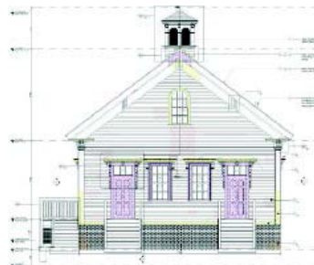
Ejemplo de un dibujo de alzado a escala y acotado con condiciones anotadas
